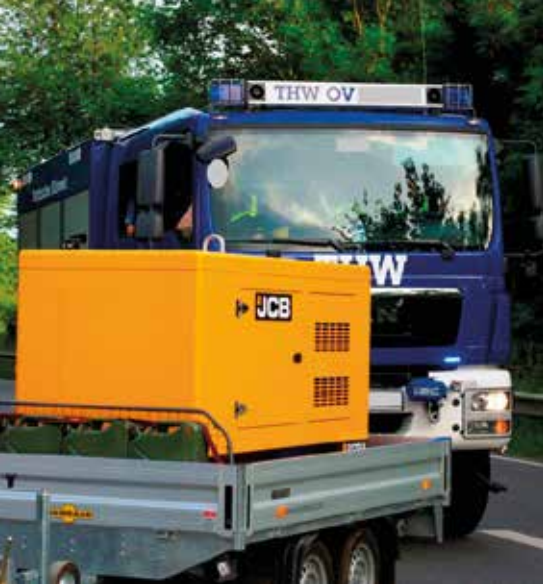
THW mit einer mobilen NEA für das Digitalfunknetz
