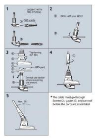
Verwenden Sie KEINE zusätzlichen Dichtungsmittel zur Montage.
